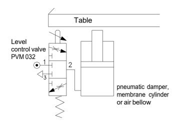
Die Druckluftversorgung ist mit einem Druckregler auf maximal 8 bar zur begrenzen. Die bereitgestellt Druckluftversorgung ist mit einem Wasserabscheider zu entfernen von Dampf und einen Luftfilter zum Entfernen von Staub und Fremdkörper auszuführen.
